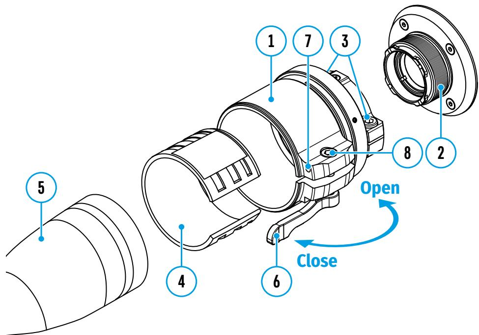
Gli adattatori PSP-42, PSP-50 e PSP-56 sono progettati per installare dispositivi Krypton sugli obiettivi di vari dispositivi diurni. Il kit degli adattatori include inserti adattatore, chiavi esagonali e nastro biadesivo.
