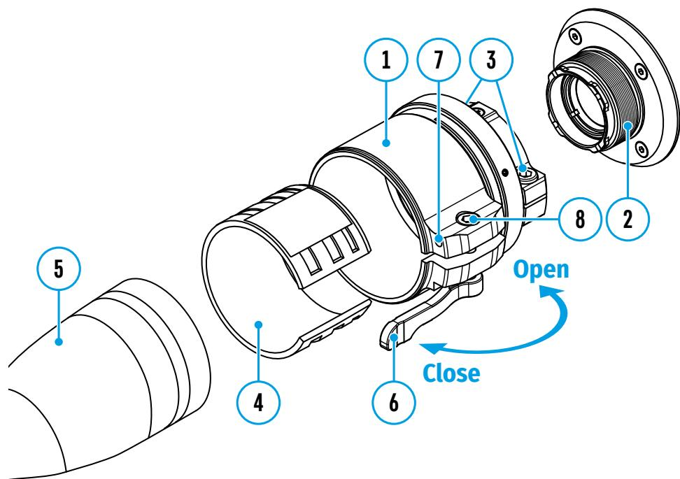
Die Adapter PSP-42, PSP-50 und PSP-56 sind für die Installation von Geräten Krypton an Objektive verschiedener Tageslichtgeräte ausgelegt. Das Adapter-Kit enthält Adaptereinsätze, Inbusschlüssel und doppelseitiges Klebeband.
