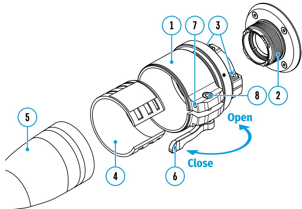
Les adaptateurs PSP-42, PSP-50 et PSP-56 sont conçus pour monter des appareils Krypton sur les objectifs de divers appareils optiques de jour. Le kit d'adaptateur comprend des inserts d'adaptation, des clés Allen et du ruban adhésif double face.
