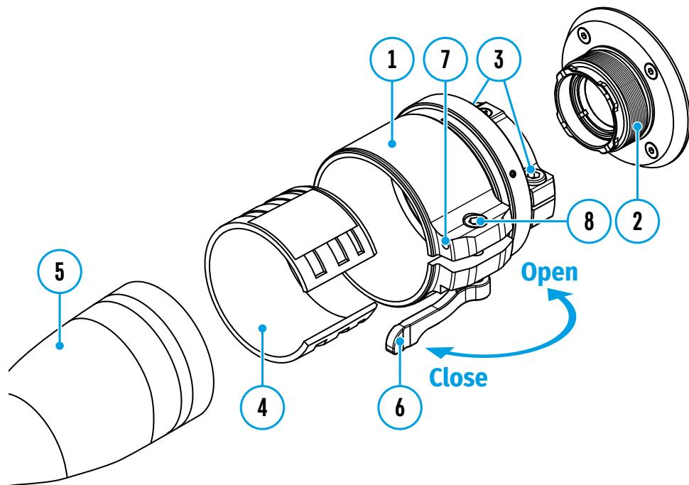
Адаптеры PSP-42, PSP-50 и PSP-56 предназначены для установки приборов Krypton на объективы различных дневных приборов. В комплект адаптеров входят переходные вкладыши, шестигранные ключи и двусторонний скотч.
