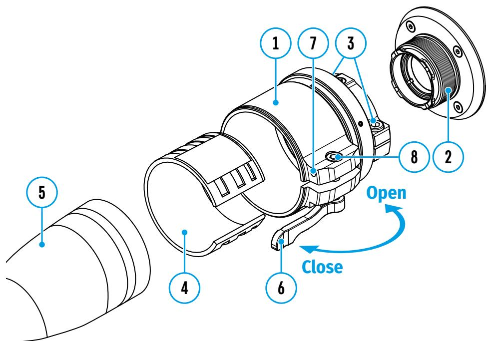
Los adaptadores PSP-42, PSP-50 y PSP-56 están diseñados para instalar dispositivos de Krypton en las lentes de diversos dispositivos diurnos. El paquete de entrega del adaptador incluye casquillos adaptadores, llaves Allen y cinta adhesiva de doble cara.
